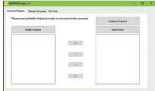
Erscheint die Fehlermeldung „No Chipcard Reader“ kann es an einer falsch gesteckten Chipkarte, einen mangelhaften Anschluss des Chipcard-Readers oder am fehlenden Treiber des Chipcard-Readers liegen. Der Treiber für den Chipcard-Reader befindet sich im TERRATEST.Utility-Downloadordner "Driver Chipcard-Reader" (siehe Punkt 8.2.3, Seite 67). Durch Doppelklick auf die sich darin befindliche Datei wird die Installation des Treibers gestartet.
