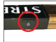
Schalten Sie den Messcomputer aus. Trennen Sie den STREAM-Dongle vom USB-Port des Messcomputers und drücken Sie den seitlichen Taster. Halten Sie den seitlichen Taster solange fest bis eine Status-LED auf der Oberseite des STREAM-Dongle weiß leuchtet. Sobald Sie die Taste wieder loslassen blinkt die Status-LED als Zeichen für die Bereitstellung des WLAN-Netzes.
